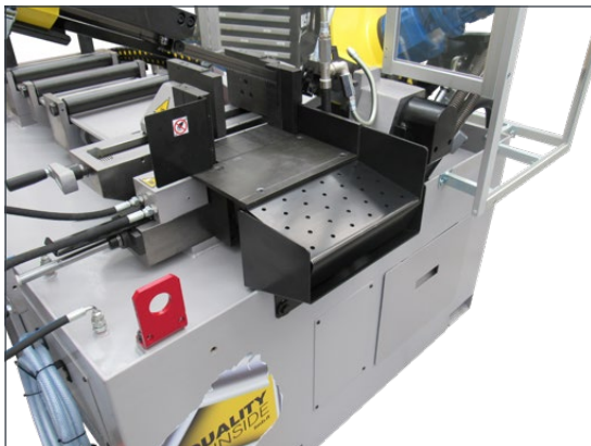
SP-ZEUS+CN Scivolo uscita pezzi per Zeus+CN. Slide for cut pieces for Zeus+CN.
