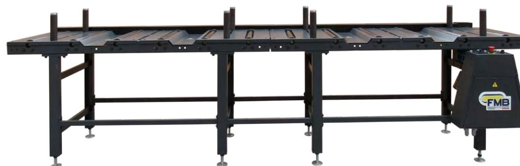
**RMP** Rulliera motorizzata pesante. *Heavy motorized roller table.*
