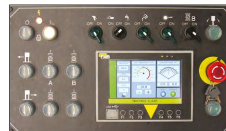
Pannello comandi touch screen con contapezzi e visualizzazione velocità avanzamento arco.
