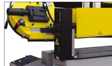
Finecorsa di taglio regolabile e finecorsa alzata lama regolabile.
