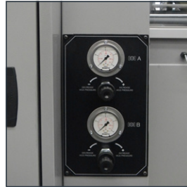
RPM2 Reglage de la pression de serrage des étaux. Regulierung der Druckstärke der Spannvorrichtung.
