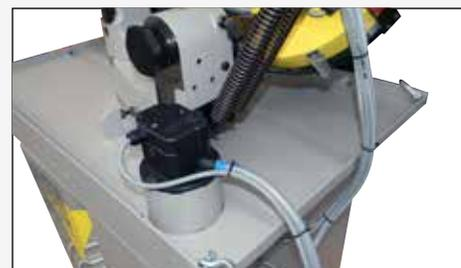
Bac réfrigérant de 12 L intégré dans la partie supérieure du bâti, avec bouchon de vidange.
