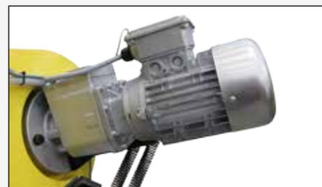
Réducteur à engrainages à dents inclinées, cémentées, rectifiées et lubrifiées avec du graisse à longue durée.
