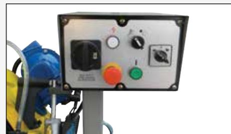
Panneau de contrôle avec contrôles auxiliaires à 24V AC protégé contre courants magnétiques et thermiques.
