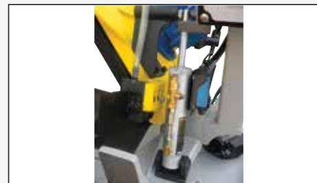
Cylindre Hydraulique pour la régulation de la descente de l'archet pendant l'utilisation en modalité gravitationnelle.
