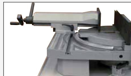
Le groupe de blocage glisse transversalement sur la plaque pour permettre des coupes à angle soit à droite soit à gauche.
