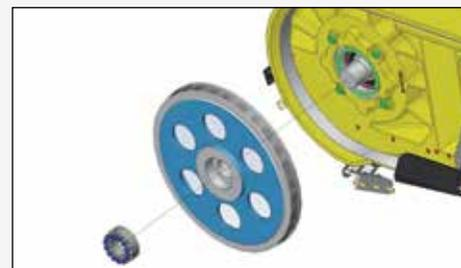
Réducteur à arbre portant qui ne nécessite aucun entretien (graissage).
