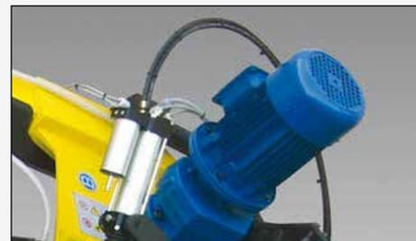
L'option G permet de couper le matériel sans l'action manuelle de l'avancement de la coupe faite par l'opérateur.
