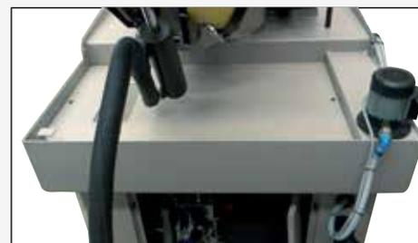
Bac réfrigérant de 40 L intégré dans la partie supérieure du bâti, avec bouchon de vidange.
